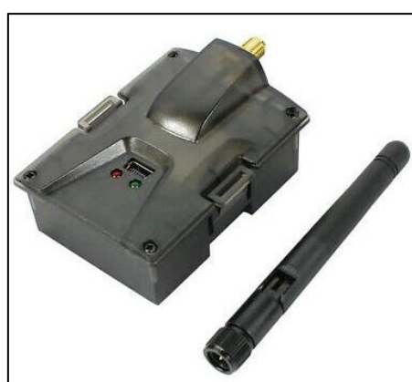
Externes MPM 4in1 HF-Modul mit USB
