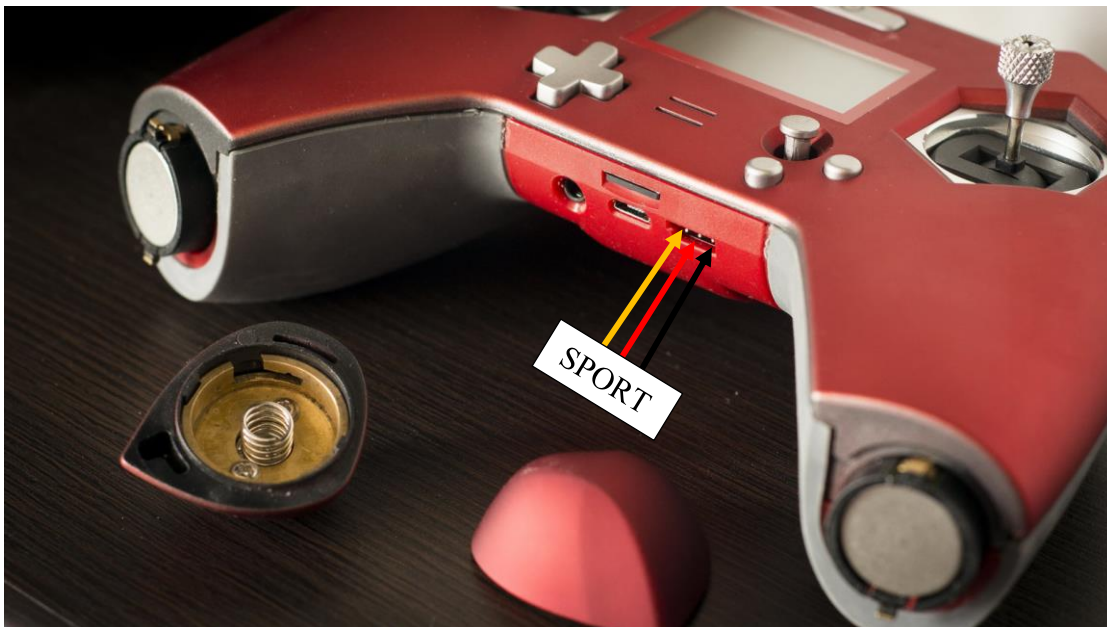
SD-Karte, Kopfhörer, USB-Buchse, Sport-Buchse
