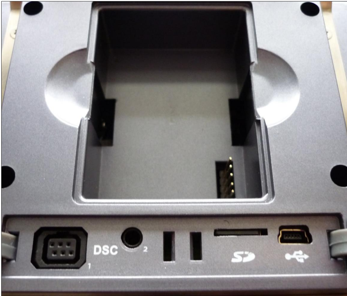
2 DSC-Buchsen (Futaba und Klinke) JR Modulschacht und Anschlüsse für SD-Karte und Mini-USB
