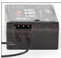
Smart-Port für Telemetrie
