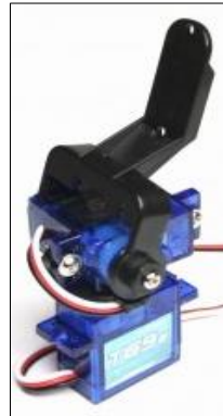
Kamerahalterung Mit 2 Servos Pan= hin/ her Tilt = auf / ab
