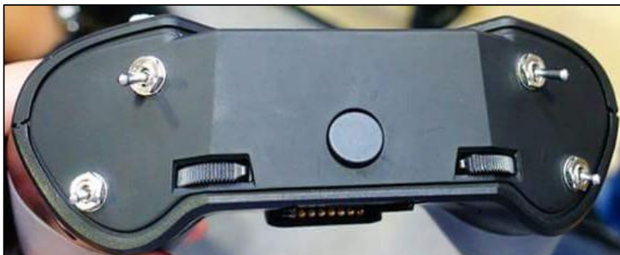
4 Schalter, 2 Slider, zusätzliche externe Antenne unter Stöpsel
