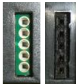
Buchsen von 2 versch. Externen Modulen im Vergleich gut schlecht
