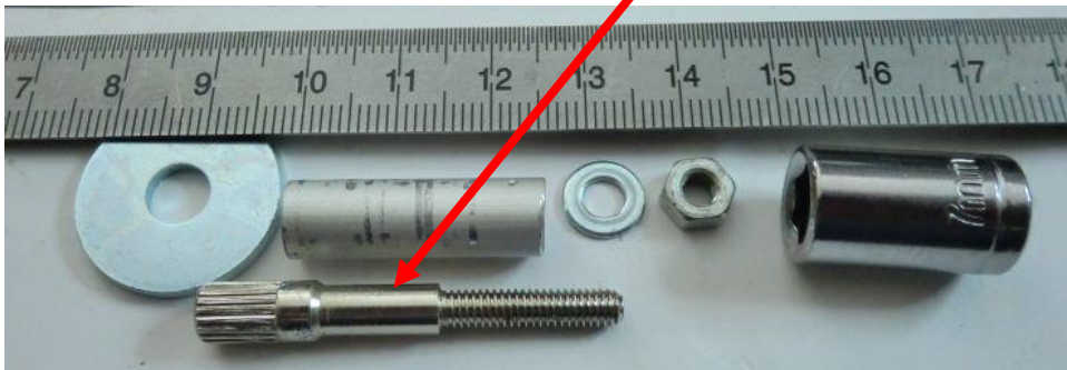
Original Bolzen mit 6mm Rändelung und 5mm Hals, Bohrung 2,5mm
