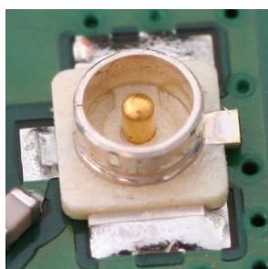
IPEX U.FL-Stecker U.FL Buchse Lötsocket 2mm Außendurchmesser
