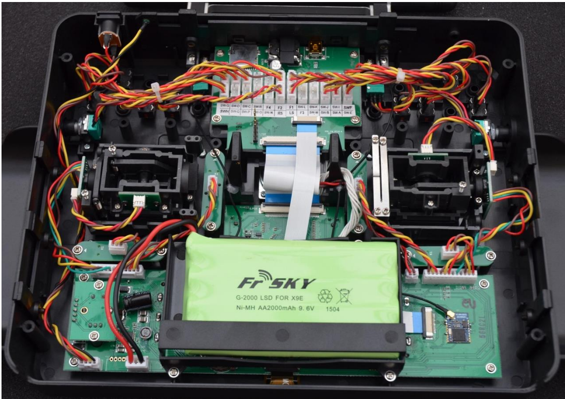
Kleine Platine links ist der Drehgeber, daneben sieht man den Elko 100µF/16V
