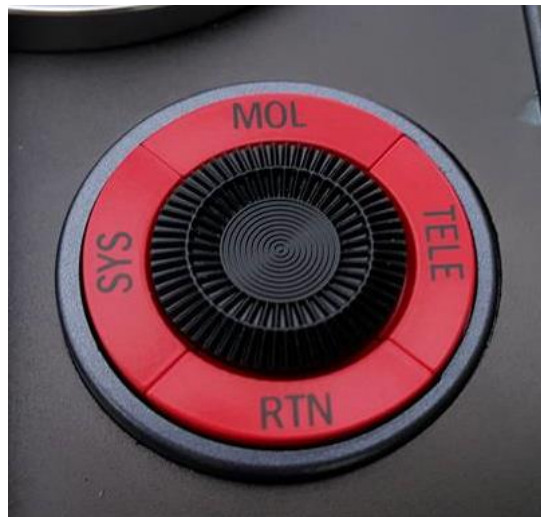
Joystick und Drehgeber zur Eingabe
