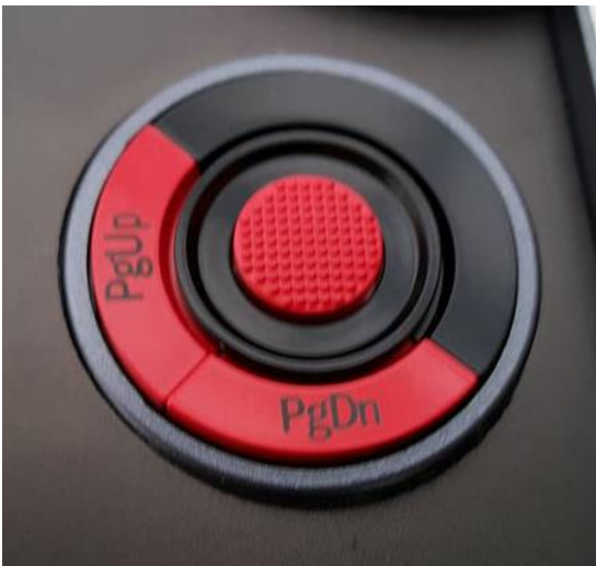
Joystick und Drehgeber zur Eingabe
